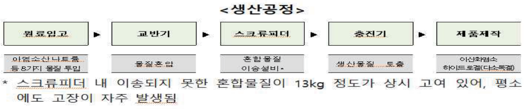
[그림] 하이드로겔 대량생산 설비 출처:산학연력 기술개발사업 최종보고서('20.10.30.)
