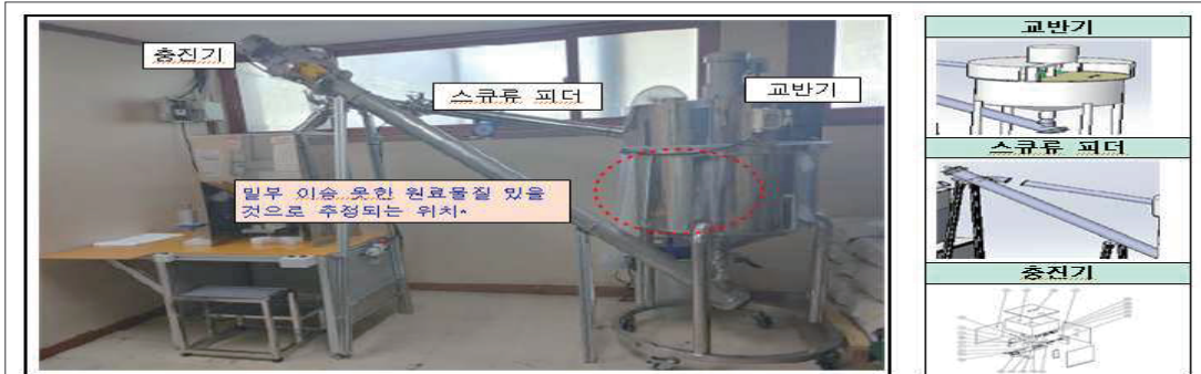
[그림] 하이드로겔 대량생산 설비 출처:산학연력 기술개발사업 최종보고서('20.10.30.)
