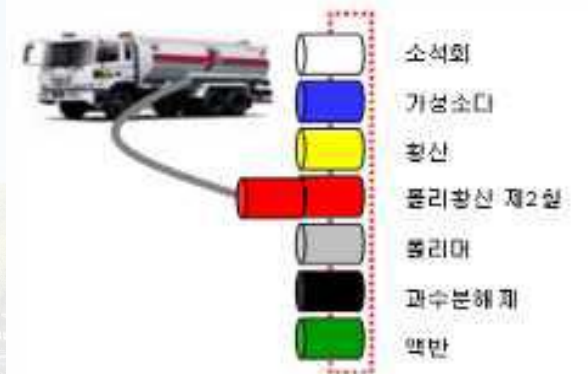
Tank Lorry 물질 주입구
