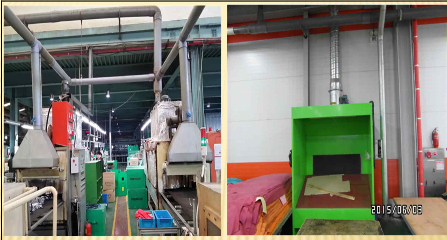
배출시설이 가동되지 않는 상태에서 공기가 방지시설로 흡입되는 상태
