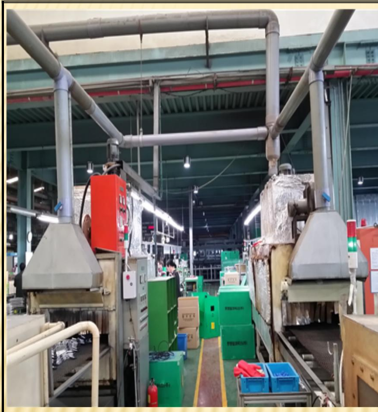
배출시설이 가동되지 않는 상태에서 공기가 방지시설로 흡입되는 상태
