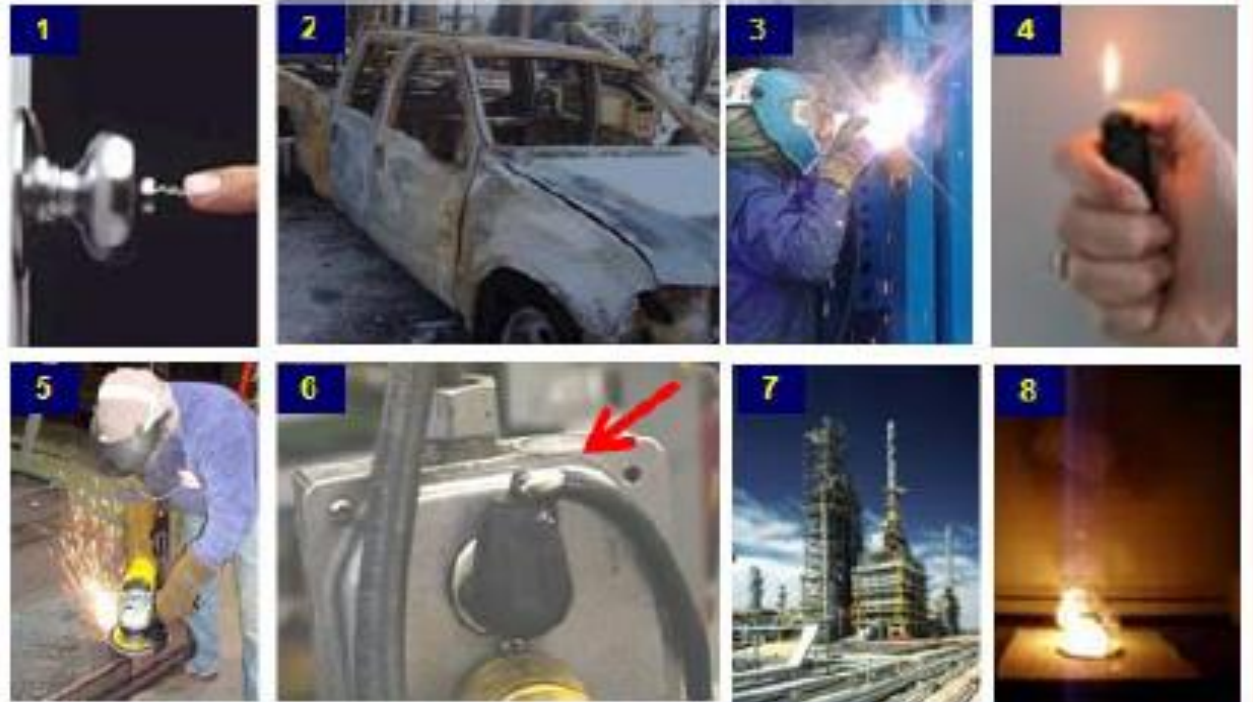
점화원의 예: (1) 정전기, (2) 지동차, (3) 용접 작업, (4) 니화(open flame), (5) 연마 작업, (6) 전선 결함, (7) 음광로, (8) 지면발화성물질 또는 자기분해성물질
