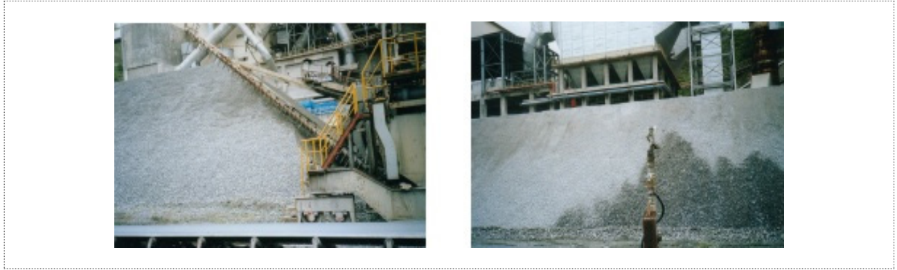
〈 원료 사전 혼합(좌) 및 스프링 쿨러 설치 모습(우) 〉
