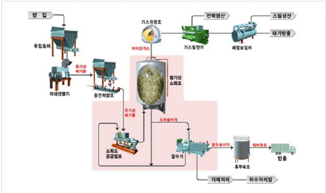
〈 음식물류폐기물을 이용한 바이오가스 제조 및 사용공정(예)(Dranco Process) 〉
