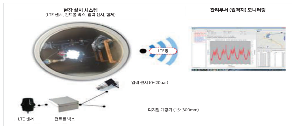
[그림 1] 소규모 급수 구역 최적 유량 및 수압 감시 시스템 구성도
