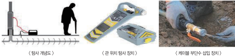
[그림 5.2] 극저주파를 이용한 관 위치 탐사
