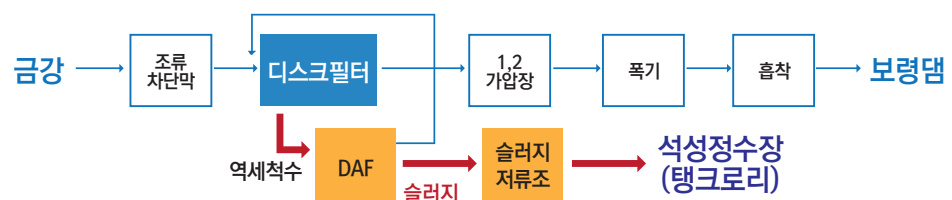
[그림 2.3] 보령댐 도수로 취수시설 현황 (연계처리 개선)
