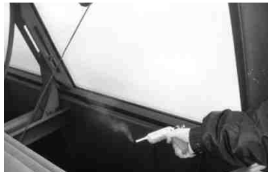
스모크 건을 이용한 기류 확인
