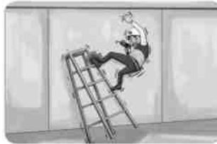
사다리 파손이나 헛디딤에 의해 실족
