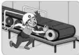
컨베이어 화물작업 중 회전 하는 체인에 말림
