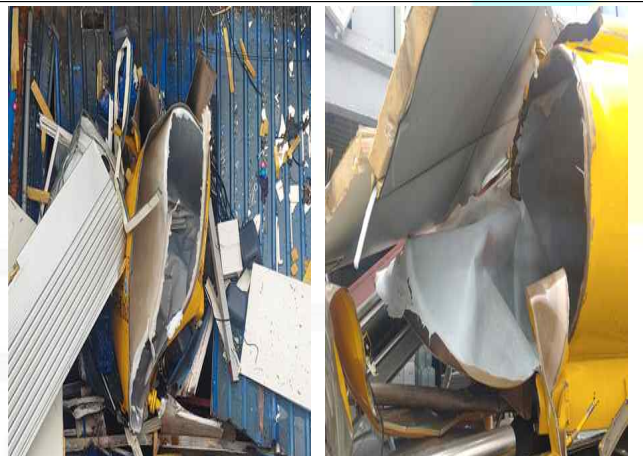
[사진 2] 파손된 탱크로리 격실(#3), 격실(#2)
