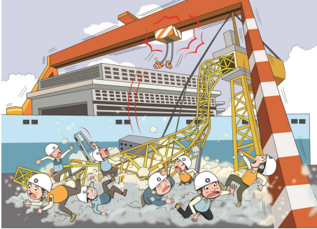
- 조선소 골리앗크레인과 지브크레인이 충돌하여 지브크레인의 메인지브가 낙하하여 6명 사망 25명 부상
