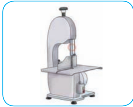
골절기칼날 방호덮개 설치
