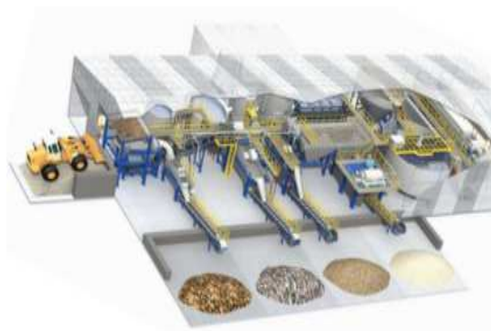
그림5. 물리화학적 처리기술(토양세척) 출처: 농어촌연구원, 2013.
